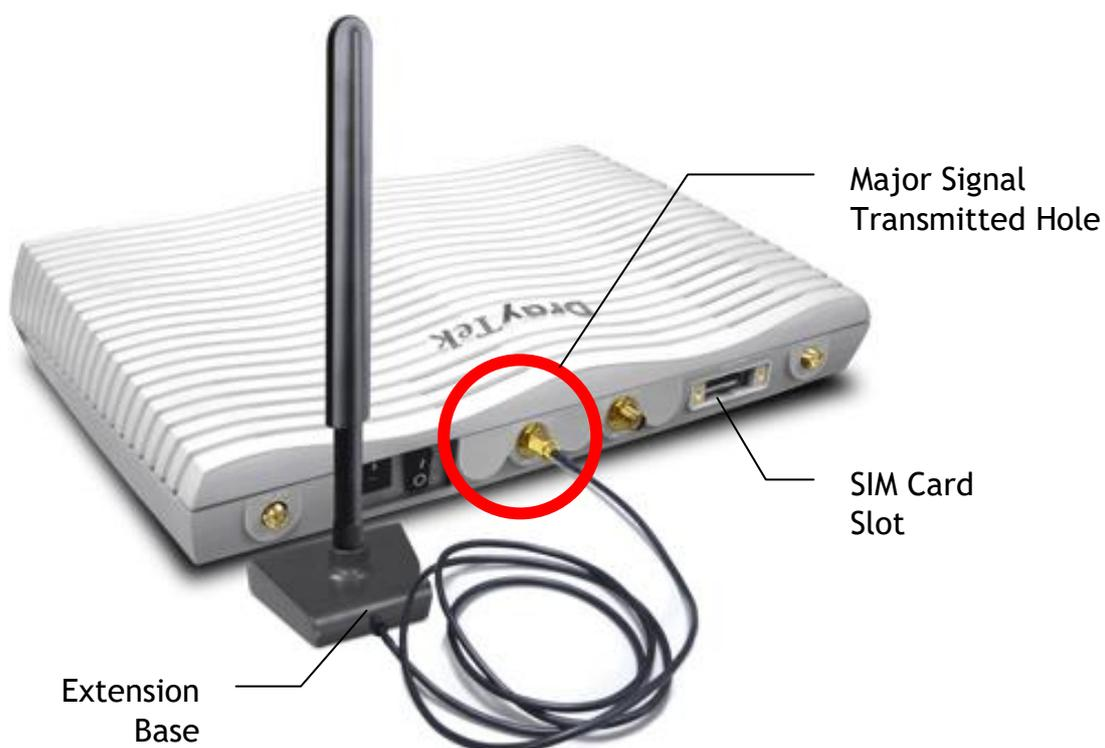
Nota : se instalar apenas uma Antena, use o orifício de montagem (Major Signal Transmitted Hole) próximo ao botão de alimentação.
